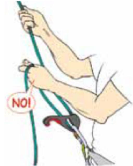
**Smart und Click-up:** Eine parallele Seilführung durch zu hoch gehaltene Bremshand (im Bild die linke) sabotiert bei Halbautomaten die Blockierunterstützung.
