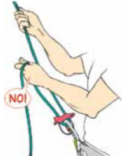
**Tube:** Beim Tube ist die zu hoch gehaltene Bremshand absolut lebensgefährlich, weil sie die Bremsmechanik des Geräts außer Kraft setzt. Bodensturz ist dann kaum zu verhindern.
